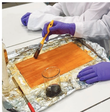
Figure 1 - Imprégnation d'une feuille avec la solution photosensible. L'utilisation d'une feuille d'aluminium comme protection des paillasse est suggérée pour limiter le nettoyage.
